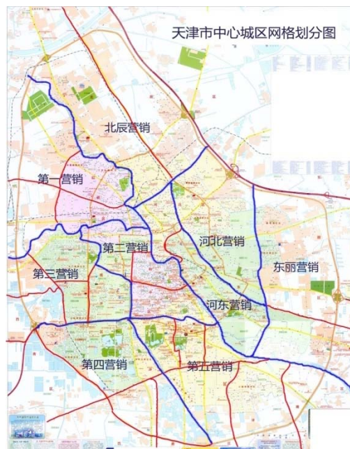
图 F-4-1 天津自来水集团三级分区计量示意图
